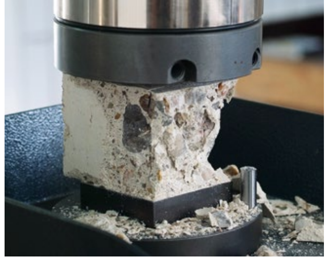
↑ Druckfestigkeitsprüfung bei einem Fließestrich.
