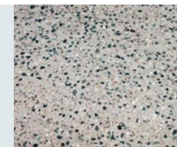
Beispiel einer geschliffenen Betonoberfläche
