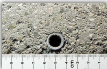
Konventioneller erdfeuchter Estrich auf Fußbodenheizung (Querschnitt): Hohlräume verhindern den schnellen Wärmetransport an die Oberfläche.
